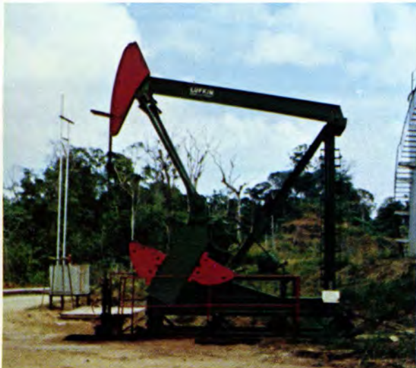
LUFKIN M-114D-143-74 Unit, Texaco Trinidad, Inc., Navette Field, Trinidad.
